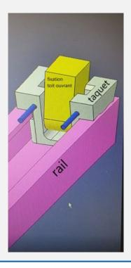
Une fois les fixations en position dans les taquets, verrouiller celles-ci en poussant les 2 axes.
